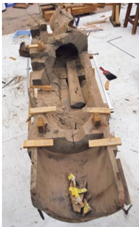
135 取り離れた直後の中間材 くさびが見える
