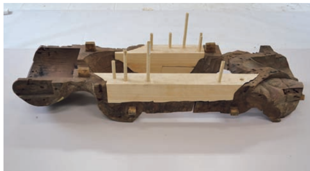
145 本体と補強材には「ダボホゾ」を設け接合
