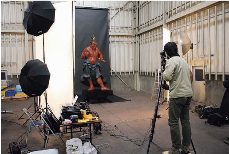
フォトVR撮影はカメラの設定が完了すると後はコンピュータ制御で自動的に360度全周撮影が開始される。
