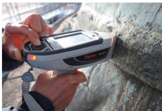
図85 可搬型蛍光X線分析装置による測定の様子
